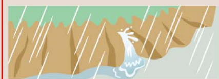
斜面（がけ）から急に水がわき出したり、わき水が濁る
