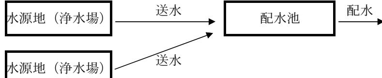
水質異常が生じた際に水源の特定が出来るよう、対象の配水区域の全水源地9箇所にて原水検査を行います。
