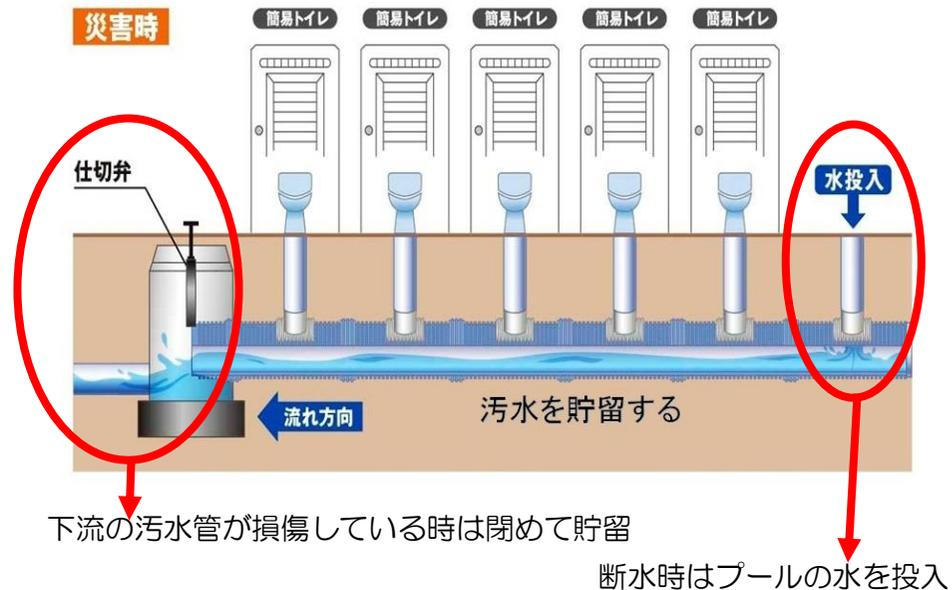
下流の汚水管が損傷している時は閉めて貯留
