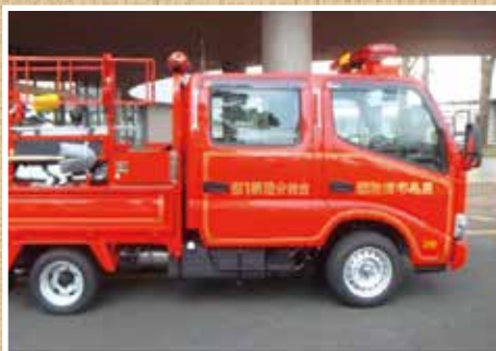
小型動力ポンプ積載車
