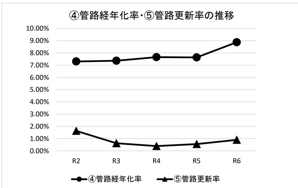
④管路経年化率 (%) = 法定耐用年数を超過した管路延長 / 管路延長 × 100
