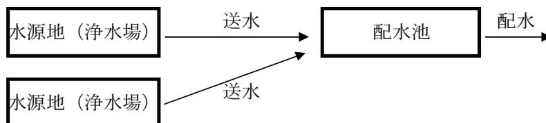
水質異常が生じた際に水源の特定が出来るよう、対象の配水区域の全水源地9箇所にて原水検査を行います。
